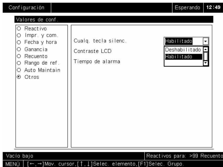
Figura 5-41 Selección del modo de silenciación del emisor de señales acústicas
